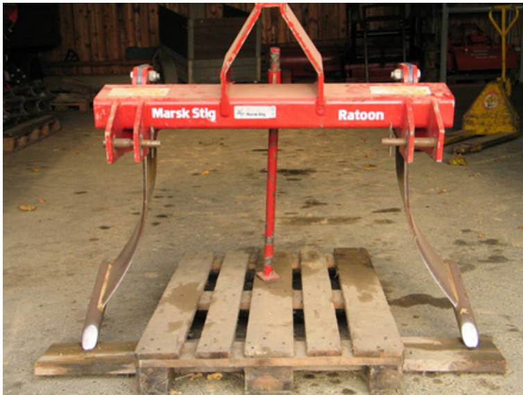
Abbildung 40: Tiefenlockerer zur Behebung von Bodenverdichtungen
