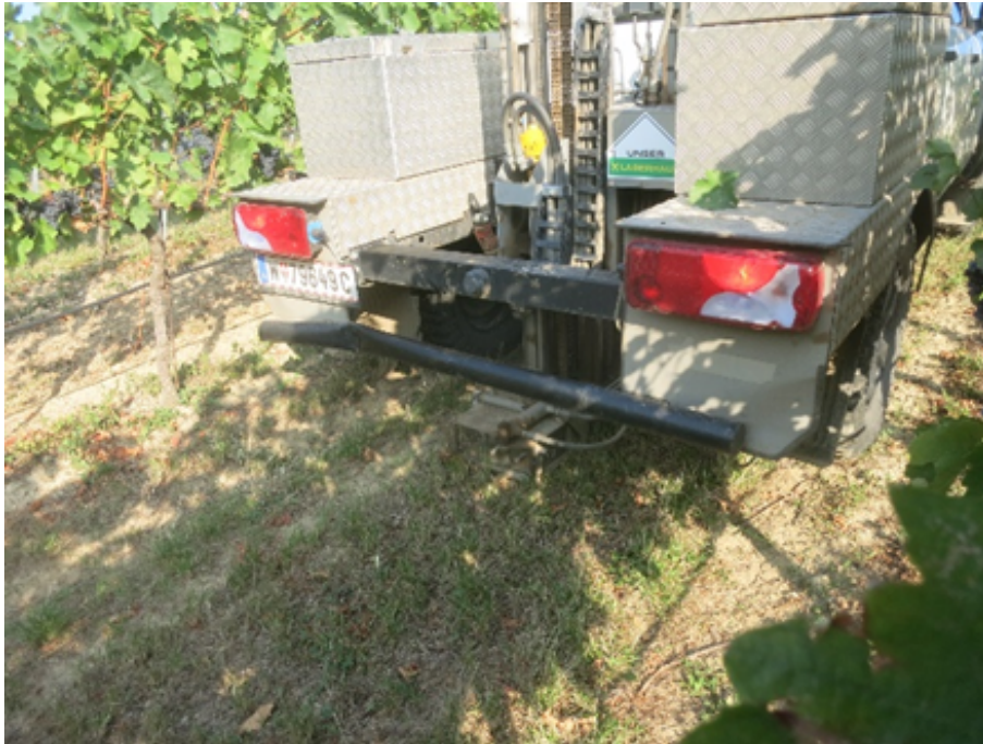
Abbildung 52: Am Auto montiertes Gerät zur maschinellen Entnahme von Bodenproben mit GPS-Verortung
