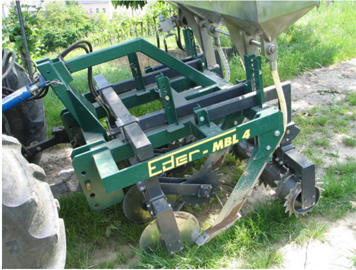
Abbildung 70: Mulchbodenlockerer mit Düngeaufsatz zur Mineraldüngereinbringung
